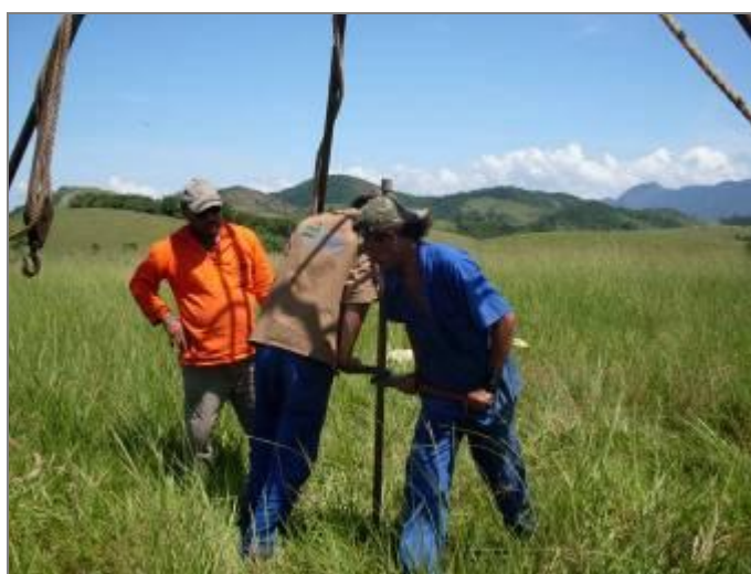
Figura 3.7-16 - Coleta das Amostras com Trado
